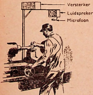
Afb. 2. Een andere toepassingsmogelijkheid voor de electronische geluidsabsorber boven het hoofd van de man aan de draalbank.
